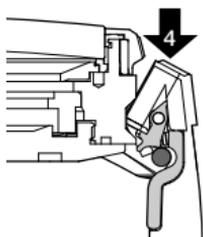
Untuk memasang rantai jam, kaitkanlah lekukan pada sambungan rantai jam ke pin pegas pada casing jam (4).
