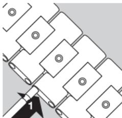
从确定的分离点重复步骤1到3。拆除多余链片，重新组装缩短的表链。
