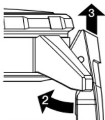
プレスレットまたはストラップを内側に傾けて(2)、ケースから離すように上側に動かします(3)。
