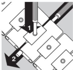
Bukalah pengait lipat dengan menekan tombol yang terdapat di bagian sisi. Letakkan rantai jam pada alas yang solid dengan sisi atas menghadap ke bawah. Sisipkan kain untuk mencegah rantai jam dan alas tergores dengan menggunakan alat bantu yang telah disediakan, Anda dapat menekan pin penahan di tempat yang dikehendaki (1) sambil mendorong pin engsel dengan alat bantu kedua sampai menonjol sekitar 3 milimeter (2).
