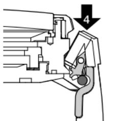
若要安装表链，请您将表耳凹槽从上而下挂入表壳的定位销中（4）。
