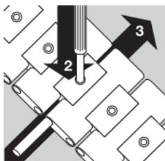
При помощи специального инструмента, включенного в комплект поставки, нажмите на предохранительную кнопку вниз (2) и одновременно полностью вставьте штифт в браслет (3).
