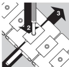
Dengan menggunakan alat bantu yang disediakan, tekanlah pin penahan (2) sambil mendorong pin engsel ke dalam rantai jam sampai tidak ada bagian yang menonjol keluar (3).
