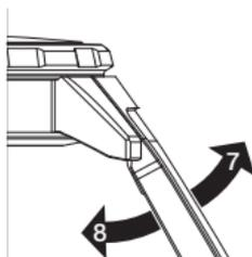
交換後には必ず、ケースの両サイドに取り付けたプレスレットまたはストラップを、上方向(7)および下方向(8)にしっかりと引き、確実に固定されているかをご確認ください。
