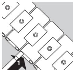
Ulangi Langkah 1 sampai 3 dengan jarak dari titik sambungan pertama yang baru saja ditentukan. Pisahkan mata rantai jam yang dilepas dan satukan rantai jam yang telah dipendekkan. Sisipkan pin engsel dari bagian samping rantai jam (1).
