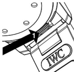
您的海洋時計計時腕錶備有專利IWC萬國錶錶鏈快速更換系統，讓您輕鬆快捷更換提供的錶鏈，無需使用工具。若要移除錶鏈，請先用大拇指向外用力按壓錶耳下方的定位桿（1）。
