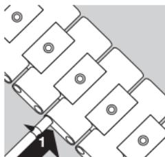
プレスレットを切り離す箇所の最初の箇所から、1～3の手順を繰り返します。不要なリンクを外し、短くなったプレスレットを再び組み立てます。
