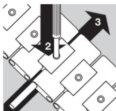
付属の専用工具で固定ピンを押し込みます(2)。同時に連結リンクを再度プレスレットに押し込んで、連結リンクとプレスレットの高さが同じになるようにします(3)。
