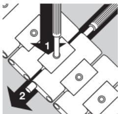
按下侧面的按钮，打开表链扣。面朝下将表链平铺在牢固的台面上。将一块软布铺于表链下方，以防止表链和台面刮伤。用附送的专业工具推下需要分离之处的安全销（1），同时用附送的另一专业工具将枢销从一侧推出约3毫米长（2）。
