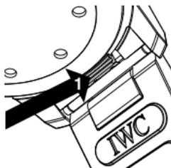
Aquatimer Chronograph Anda dilengkapi Sistem Ganti Cepat Rantai jam IWC yang dipatenkan dan memungkinkan jenis rantai jam yang disediakan diganti secara mudah dan tanpa peralatan. Untuk melepas rantai jam, gunakan kuku jempol Anda untuk mendorong tuas penahan (1) di bagian bawah sambungan rantai jam ke arah luar.
