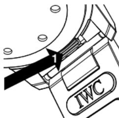
Ваши часы Aquatimer Chronograph оснащены запатентованной IWC системой быстрой смены браслета или ремешка, позволяющей Вам быстро и просто заменить браслет или ремешок без использования инструментов. Для отсоединения браслета или ремешка с усилием нажмите ногтем большого пальца на предохранительный рычажок (1), расположенный на внутренней стороне между ушками крепления.
