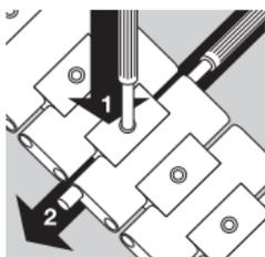
折り畳み式クラスプの両側にあるプッシュボタンを押してクラスプを開きます。安定した台の上に、外側を下にしてブレスレットを置きます。ブレスレットとブレスレットを置いた台が傷つくのを防ぐため、布を敷いて作業をすることを お勧めいたします。付属の専用工具を用いてブレスレットを切り離す箇所の固定ピンを押しながら(1)、
