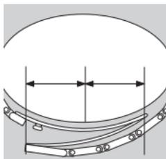
將腕錶戴在手腕上，扣上折疊扣，借助疊置法估計需要拆卸的鏈片節數。您可按照一些說明拆卸：若要拆下多個鏈片來縮短錶鏈，建議您盡量在兩側錶鏈上取下相同數量的鏈片，使得錶鏈扣基本處於手腕中央。
