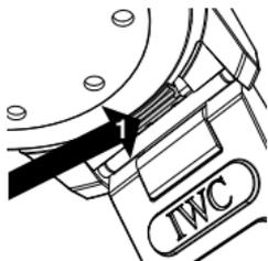
您的海洋时计计时腕表备有专利IWC万国表表链快速更换系统，让您轻松快捷更换提供的表链，无需使用工具。若要移除表链，请先用大拇指向外用力按压表耳下方的定位杆（1）。
