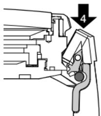
プレスレットまたはストラップを取り付ける際は、ラグの切り込みをケースのスプリングピンに上から引っ掛けます(4)。
