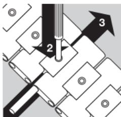
用附送的工具推下安全销（2），同时将枢销插回表链，直至表链外观平整（3）。
