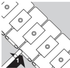
Повторите действия 1–3 на некотором расстоянии от первого места разъединения. Снимите лишние звенья и соедините концы укороченного браслета.
