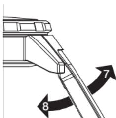
更换后请用力向上（7）并向下（8）拉伸两侧表带，以检查表带是否安装牢固。
