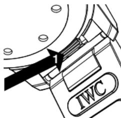
アクアタイマー・クロノグラフにはIWCの特許取得した「プレスレットクイック交換システム」が搭載されています。工具を使うことなく、素早く簡単にプレスレットまたはストラップを交換することができます。プレスレットまたはストラップを外す時は、突起部の裏側にあるロックレバーを外側に向けて親指で力強く押します(1)。
