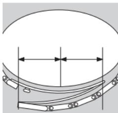
フォールディング・バックルを閉じた状態で時計を腕にはめ、重なる部分を利用して、ブレスレットの余分なリンク数を数えます。下記の説明にしたがって、ブレスレットからリンクを外します。ブレスレットを短くするのに複数のリンクを外す必要がある場合、バックルが手首のほぼ中央に来るように、ブレスレットの両サイドから同じ数のリンクを外してください。
