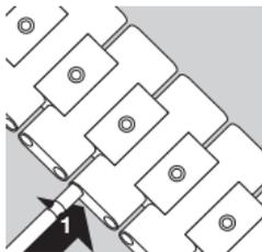
從確定的分離點處重複步驟1至3。拆除多餘鏈片，重新組裝縮短的錶鏈。
